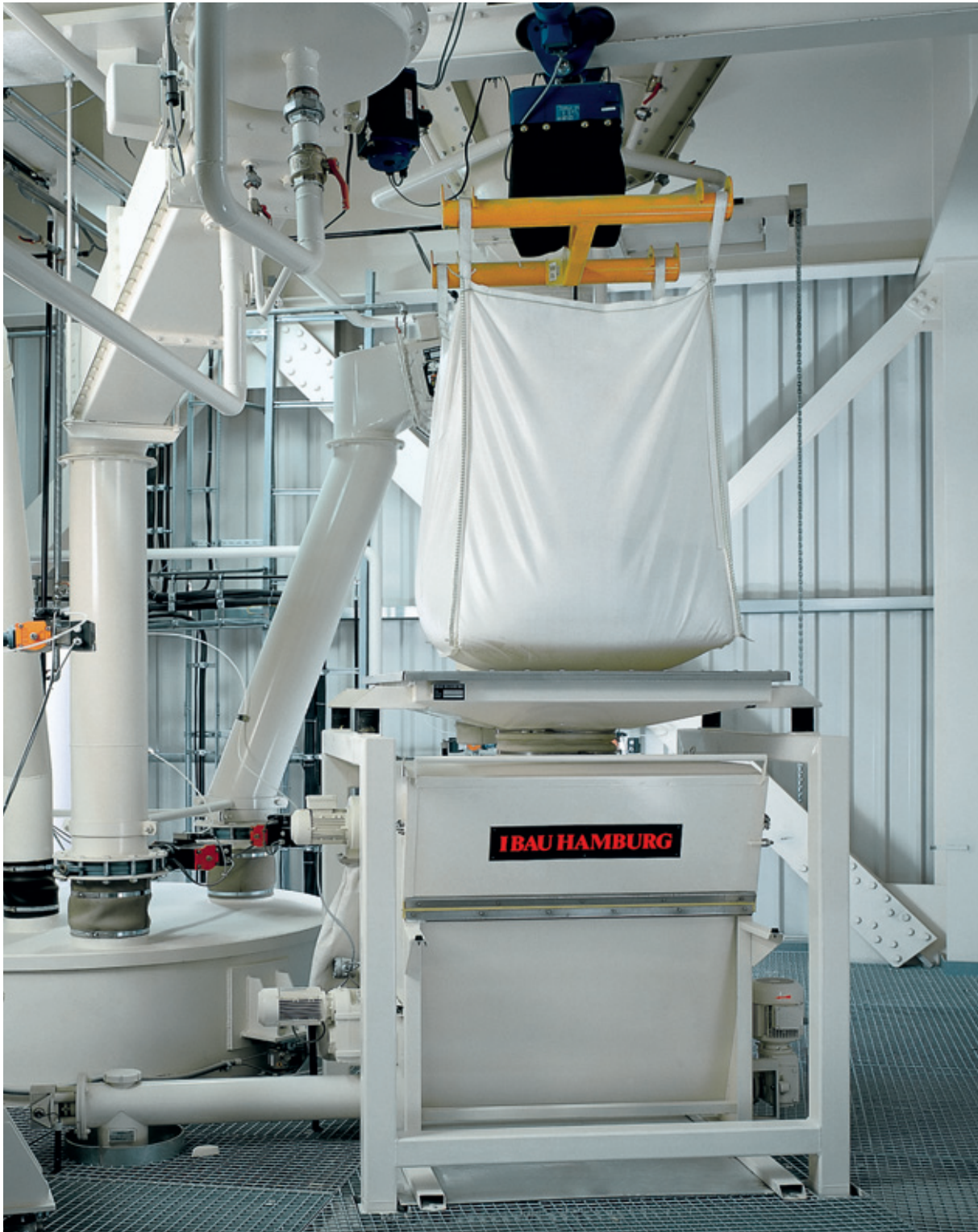
Big-Bag Entleerstation mit integrierter Dosierung
