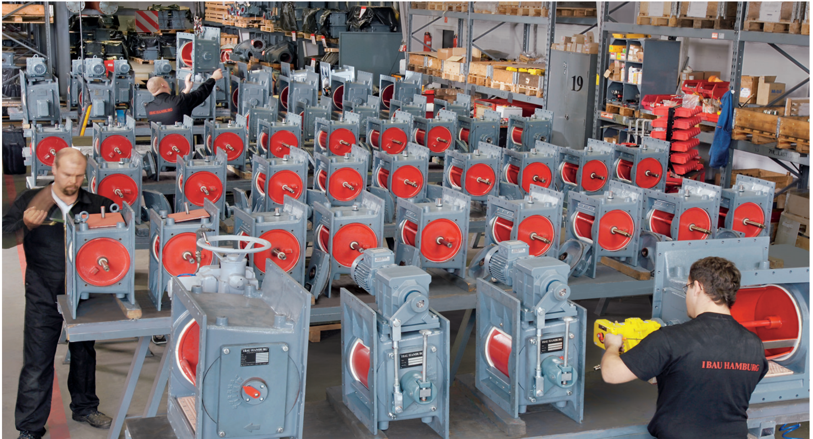
Zusammenbau von IBAU Dosierschiebern im Werk Hamburg/Allermöhe
