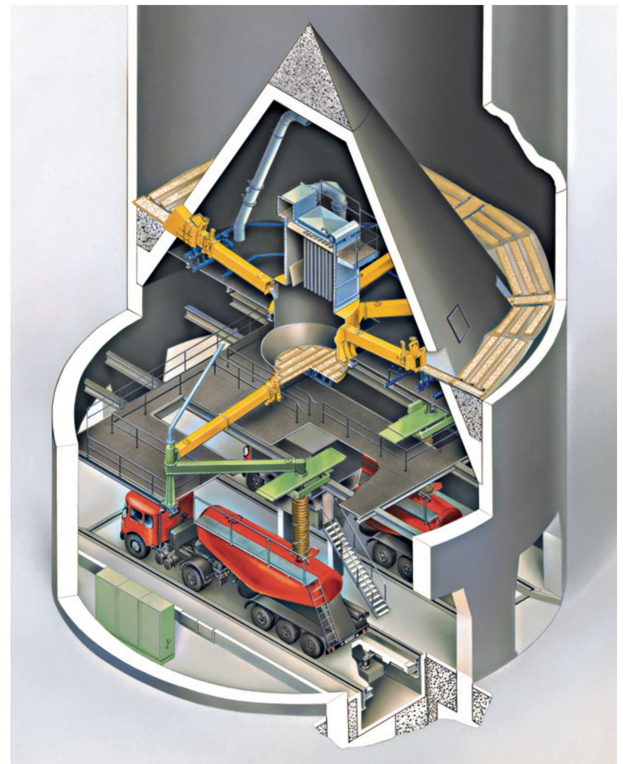
Schnittdarstellung eines Zentralkegelsilos
