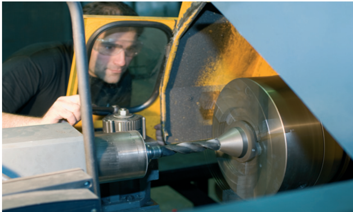
Aufbohren von Düsen nach Auftragsvorgabe
