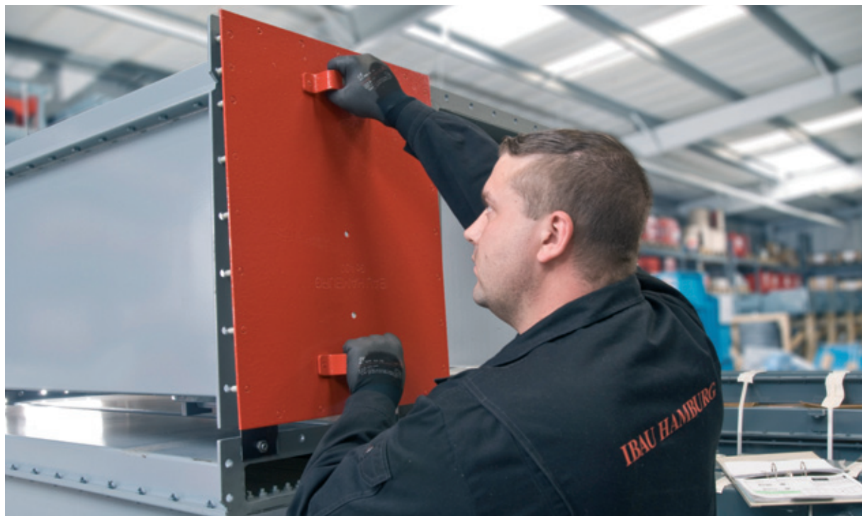
Fertigungskontrolle einer Luftförderrinne
