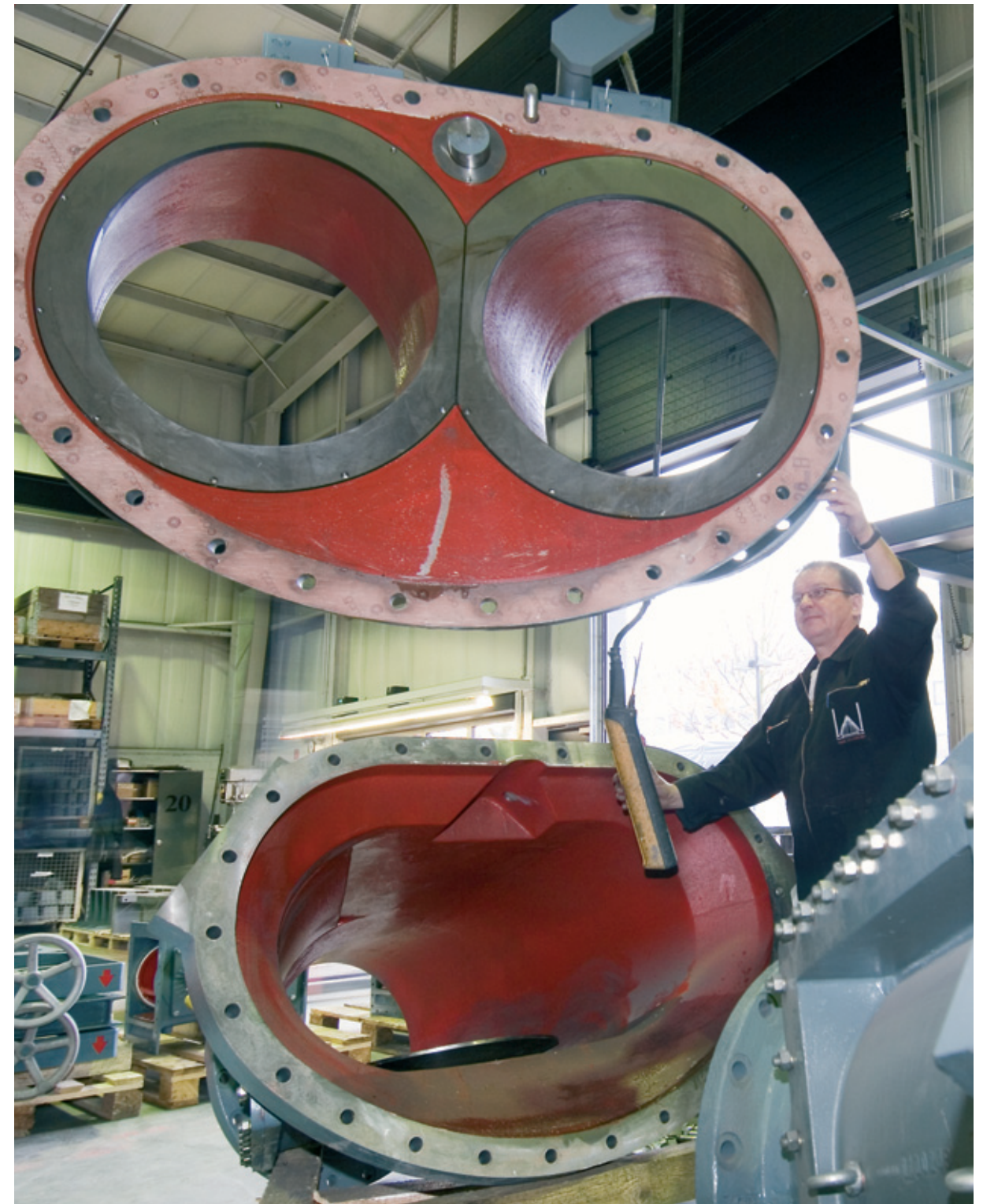
Zusammenbau eines Zwei-Wege-Ventils
