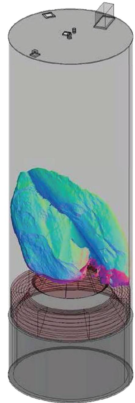
Überlagerndes Bild von 3D-Punktwolke und 3D-Silo-Modell im Maßstab 1:1
